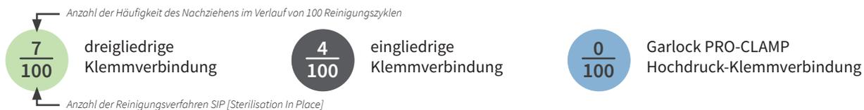
Abbildung: Häufigkeit des Nachziehens von Klemmverbindungen über einen Testzeitraum von 100 Zyklen mit Reinigungsverfahren SIP [Sterilisation In Place]
