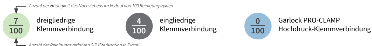
Abbildung: Häufigkeit des Nachziehens von Klemmverbindungen über einen Testzeitraum von 100 Zyklen mit Reinigungsverfahren SIP [Sterilisation In Place]
